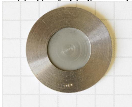
Նկար 1. Մոլիբդենի փոշին մամլված է տիտանից պատրաստված հենասկավառակի մեջ:
