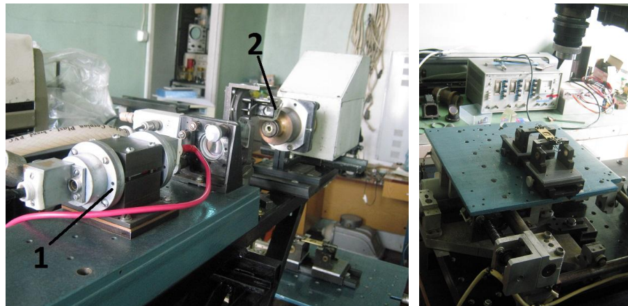
Նկար 2. Մոլիբդենի հաբի մակերեսային մշակման համար լազերային սարքավորումը (ձախում), համակարգչով կառավարվող XY երկկորդինատային շարժական սեղանը (աջում):
