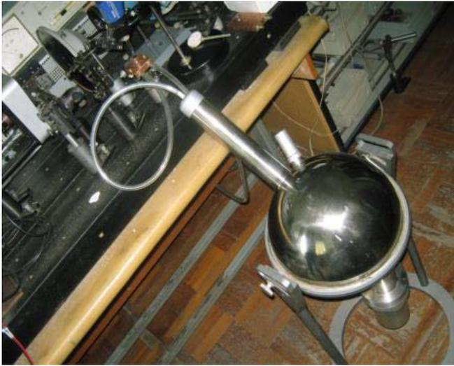
Կրիոգեն հովացման մեթոդի ստուգման համար կառուցվեց ստենդ, որում փնջի իմիտացիան կատարում էր լազերային փունջը: Պինդ մարմնային լազեր **CW 1.06** մկմ ալիքի երկարությամբ և առավելագույն **50 W** հզորությամբ նառագայթում էր թիրախի մակերեսը իբր պրոտոնային փունջն էր տախացնում այդ թիրախը: Թիրախի ջերմաստիճանը չափվում էր նախորդ նկարում բերված ջերմային գույգի միջոցով:
