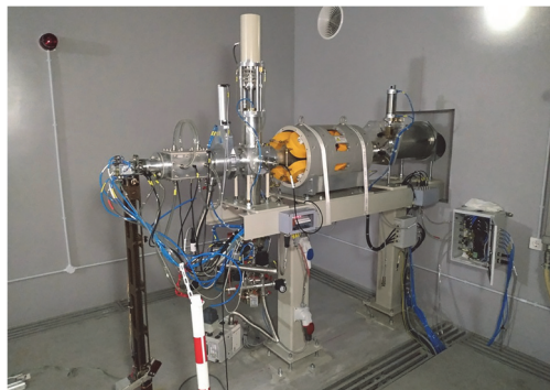
Рис.4. Пучкопровод для транспортировки пучка в экспериментальный зал.
