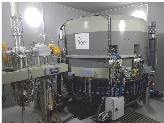
Рис.3. ИВА Циклотрон С18 с выведенным пучкопроводом.
