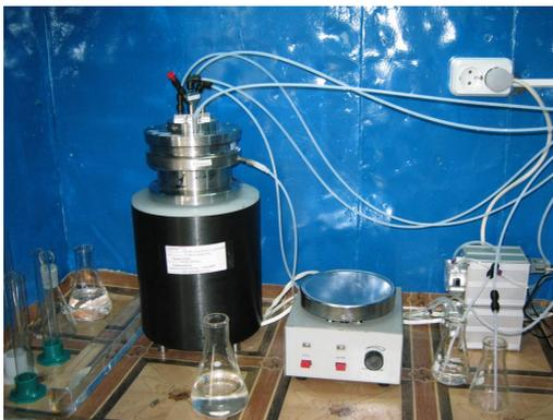
Рис. 2.7. Эстрактор, мешалка и перистальтические насосы в вытяжном шкафу.
