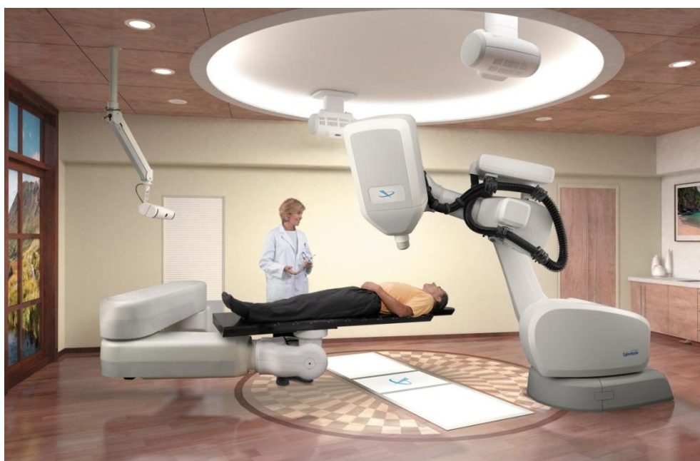
Рисунок 8. Радиохирургическая система «Кибер-Нож»
