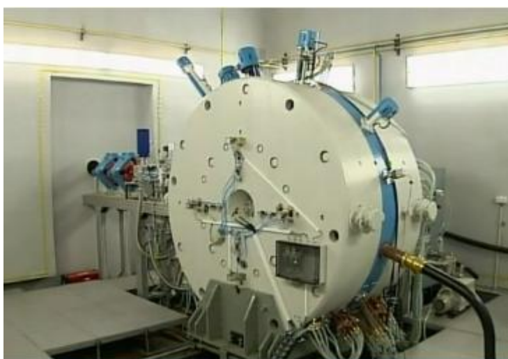
Рисунок 12. Установка для облучения нейтронами
